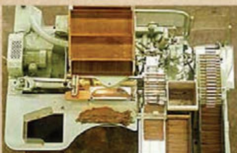
Die heutige Produktion setzt auf technisch hochentwickelte Maschinen. Diese erbringen eine Minutenleistung von 15 bis 200 Stück (zum Vergleich: Maschinen zur Zigarettenherstellung produzieren bis zu 20.000 Stück pro Minute). Neben der Beschleunigung des Herstellungsprozesses kommt die maschinelle Fertigung der gleichmäßigen Qualität zugute. Trotz modernster Technik bleibt die Herstellung von Zigarren aber sehr arbeitsintensiv. Der Lohnanteil beträgt, gemessen am Produktionswert, etwa 40 Prozent.
